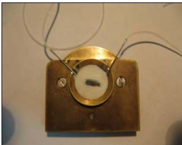
איור 26: מחזיק הדוגמא המאפשר עבודה עם זכוכיות באיכות טובה והזרמת נוזלים.
